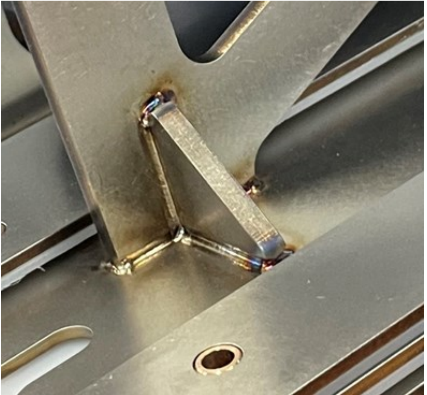
Fillet Weld No Filler Material
